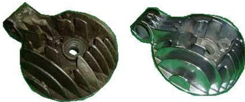
Obr. 20 Výsledek chemického leštění
