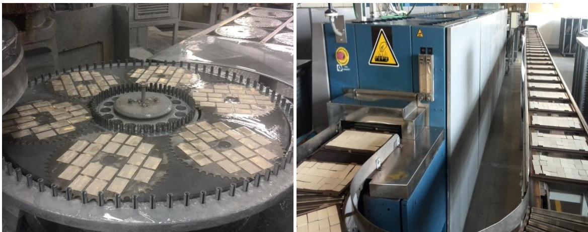
Obrázek 16 Lapování a výpal po metalizaci (Vlastní zpracování)
