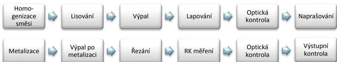
Obrázek 14 Technologický postup výroby pozistorů (Vlastní zpracování)
