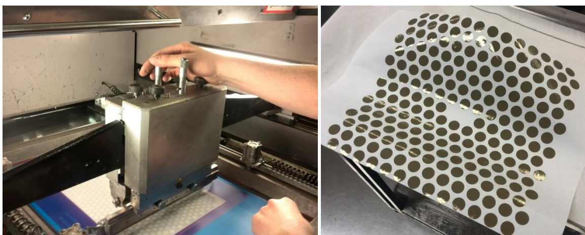
Obrázek 23 Nastavení přítlaku stěrky a potisk papíru (Vlastní zpracování)
