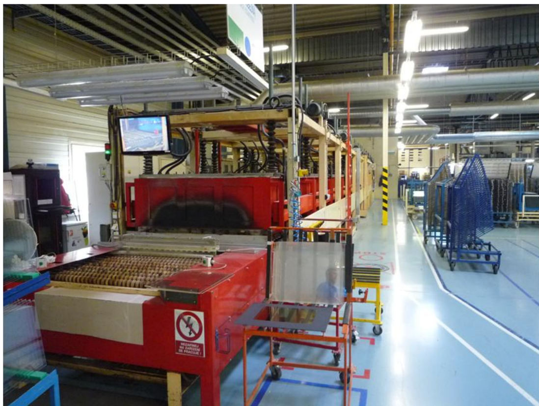
Obrázek 16 Vstupní dopravník do pece SIG (interní materiály společnosti)
