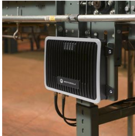
Obr. 5 Stacionární RFID čtečka (Codeware, © 2013)
