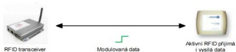
Obr. 3 Aktivní RFID systém (Sommerová, © 2010)
