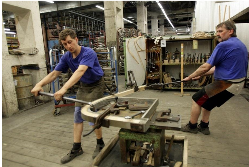
Obr. 11 Proces ručního ohýbání (Idnes, © 2013)
