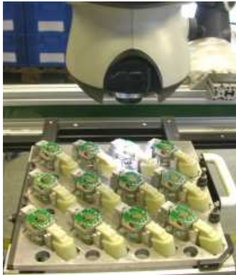
Obr. 15: Kontrola zapájených spojů (Vlastní zpracování)
