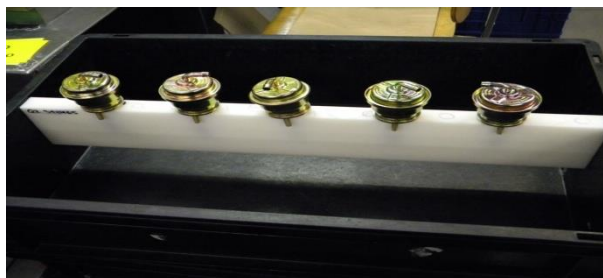
Obrázek 14: Podsestavy v zásobníku připraveny na zalemování (Interní zdroj firmy)
