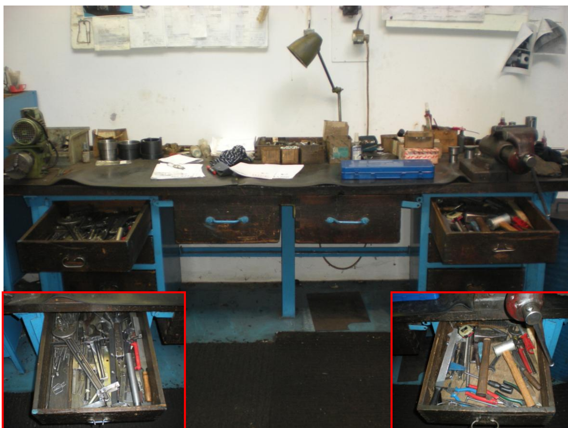
Obr. 29 Pracovní stůl montáže – volné rozmístění nástrojů (vlastní zpracování)
