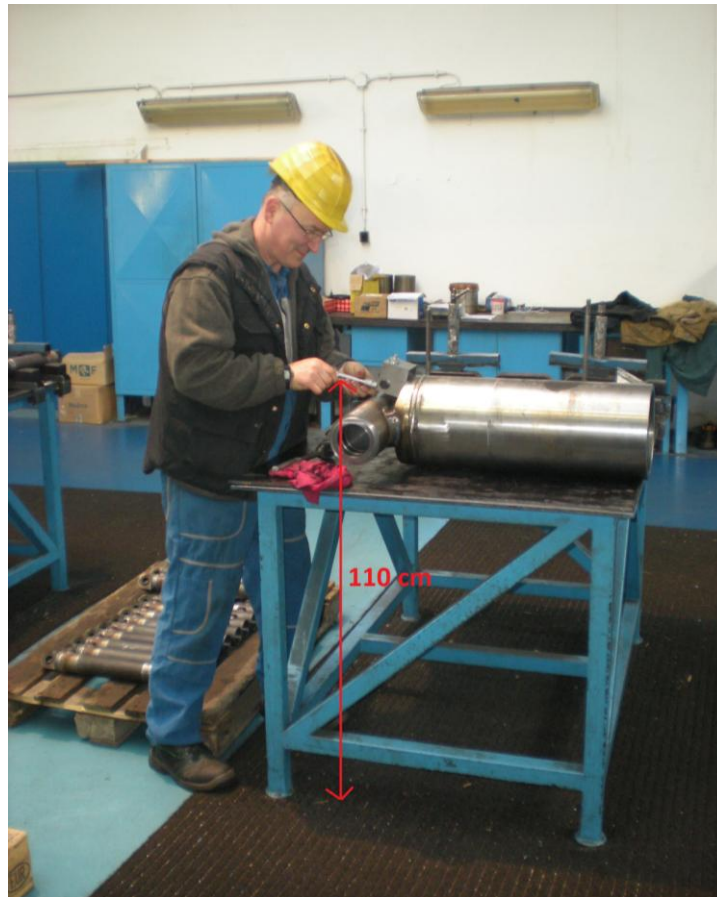
Obr. 33 Vyhovující výška pracovní roviny (vlastní zpracování)
