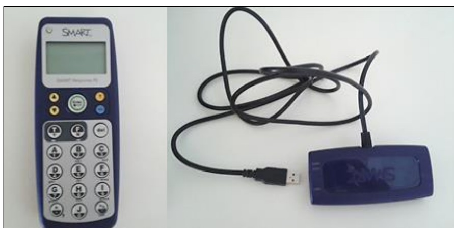
Obr. 8. Hlasovací stanička a přijímač. [foto: M. Hrubá]
