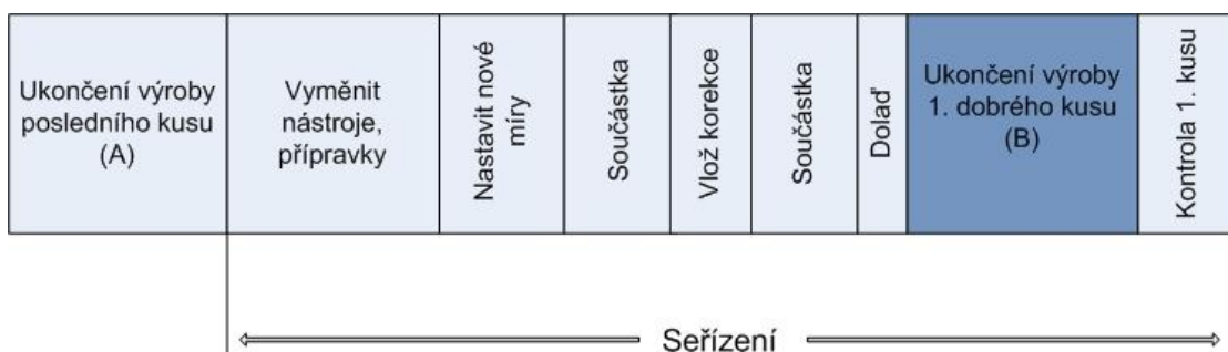
Obrázek 7 Definice seřízení (vlastní zpracování zdroje PROFIMA, 2013)
