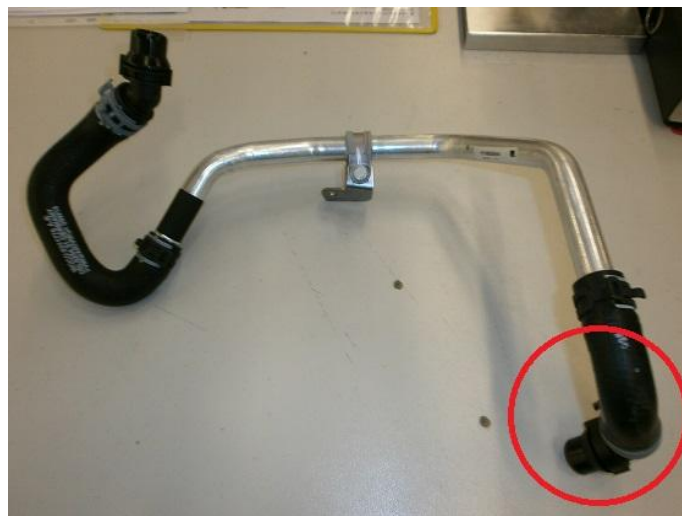
Obr. 11. Montovaná část artiklu A001 na pracovišti P6 [vlastní zpracování]
