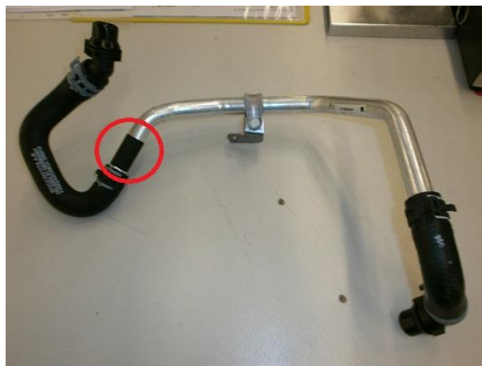
Obr. 5. Montovaná část artiklu A001 na pracovišti P1 [vlastní zpracování]
