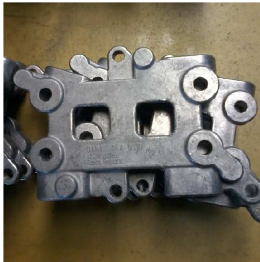
Obrázek 14: Otvory ve výrobku nutné ojehlit (Zdroj: vlastní zpracování)
