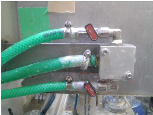
Obrázek 20 Nastavení chladicího systému (vlastní zpracování)
