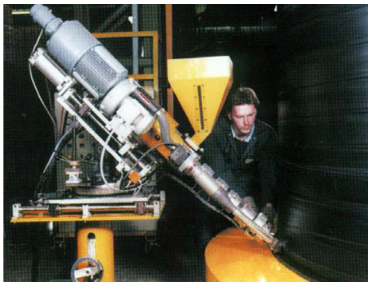
Obrázek 10: Svařování základny s vinutým válce [6]
