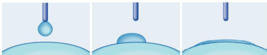
Obr. 14 Statická metoda – puštěné kapky [23]
