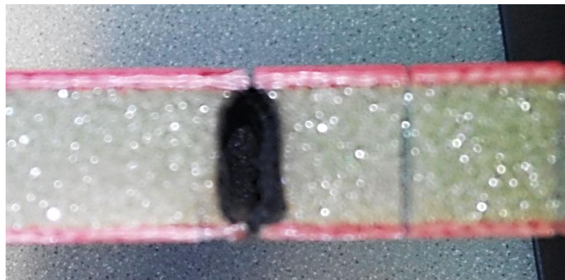
Obr. 59 Vypálený jádrový materiál při řezu laserem
