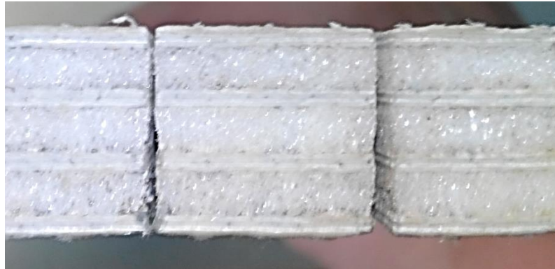
Obr. 60 Znázorněný odskok materiálu na přechodu sklo/laminát
