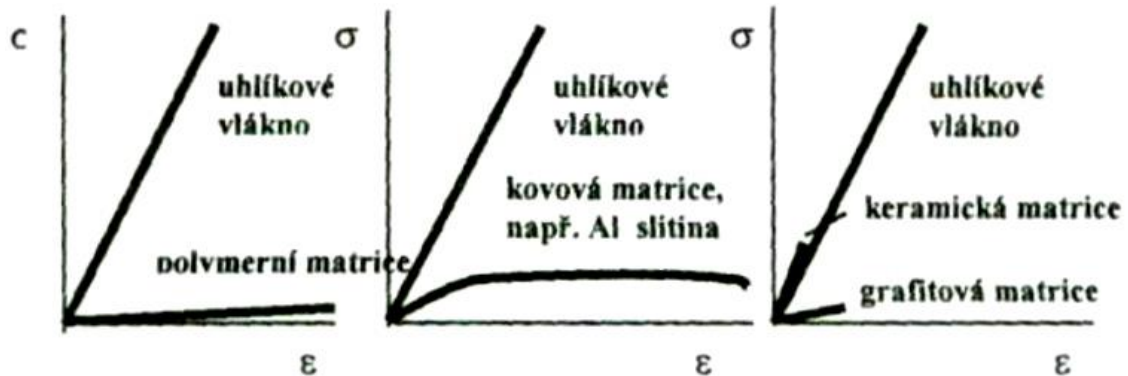
Obr. 20 Rozdíl v křivkách poměrné prodloužení – napětí vybraných matric v porovnání s uhlíkovým vláknem. [14]
