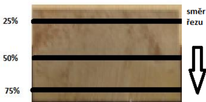
Obr. 46 Vzorky oceli s označenými hladinami a směrem řezu
