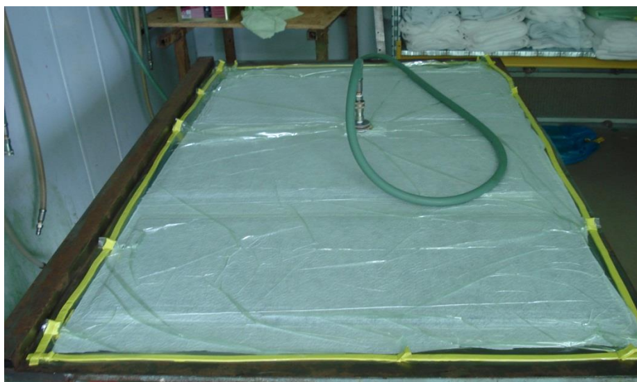
Obr. 43 Lisování desky vakuem
