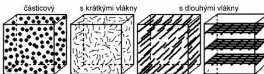
Obr. 2 Rozdělení kompozitních materiálů dle výztuže [4]
