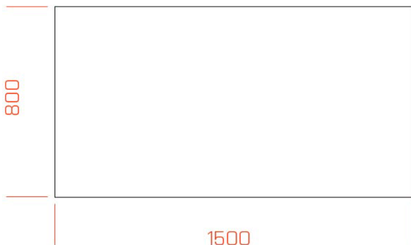
Obr. č. 22 Základné rozmery vrchnej dosky uvádzané v mm, hrúbka 10 mm
