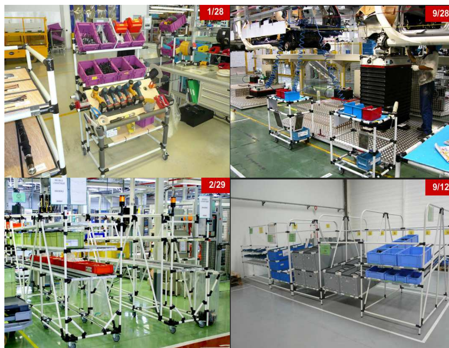
Obr. 9 Ukázka modulárních stavebnicových systémů (Trilogic, © 2012)
