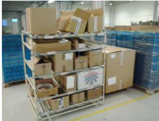
Obrázek 28: FIFO regál u linky J42 (vlastní zpracování)
