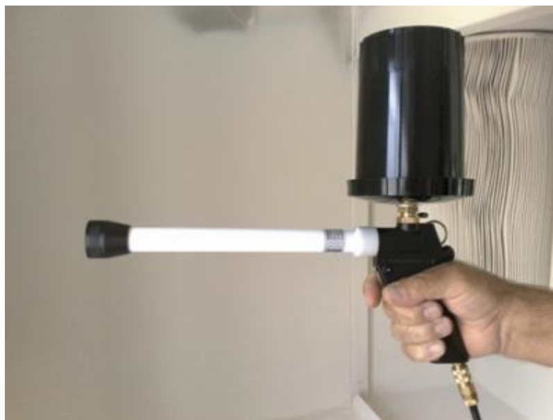
Obr. 10. Ruční stříkací tribo pistole Prsten 031 [17]
