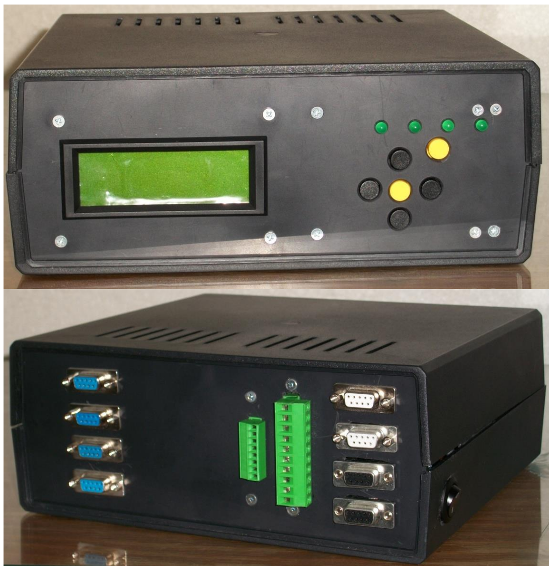
Obrázek 42: Konstrukce převodníkové jednotky [31].
