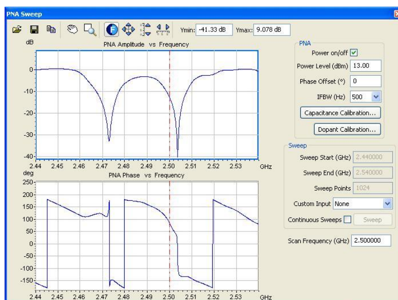
Obrázek 30.: Nastavení pracovní frekvence VNA na 2,5 GHz
