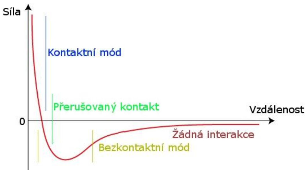
Obrázek 5.: Zóny síly interakce v závislosti na vzdálenosti hrotu a vzorku
