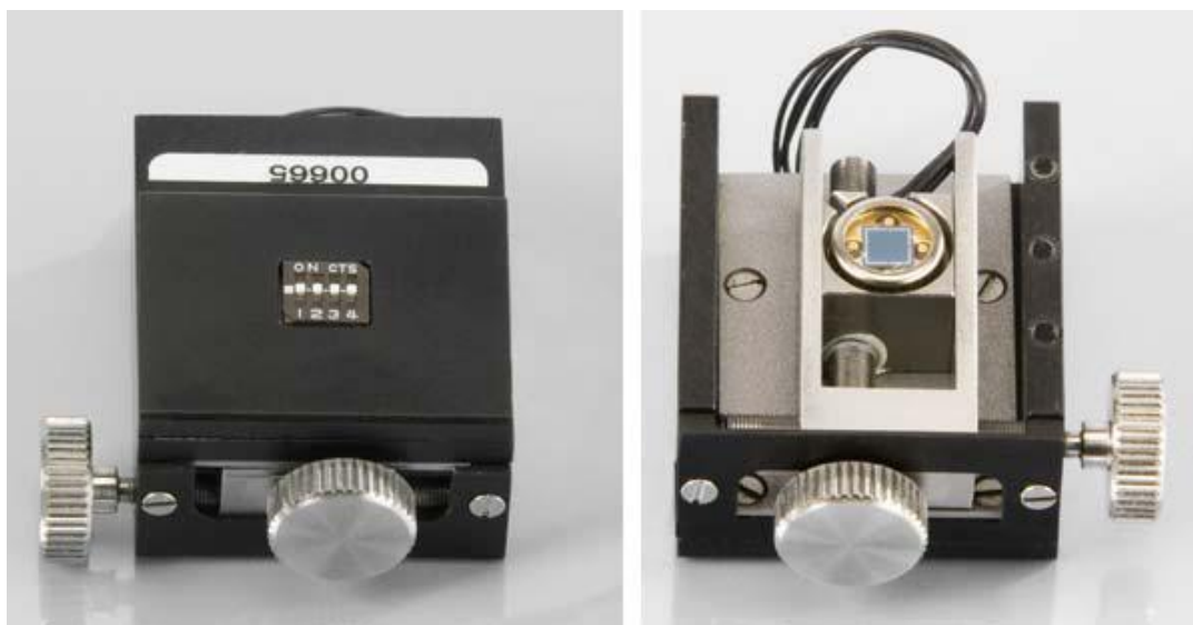
Obrázek 20.: Modul čtyřsegmentového fotodiodového detektoru. [1]
