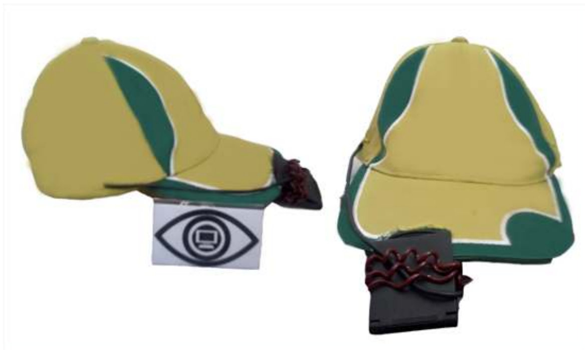
Obr. 25. Kompenzační pomůcka: webkamera umístěna na čepici s kšiltem.
