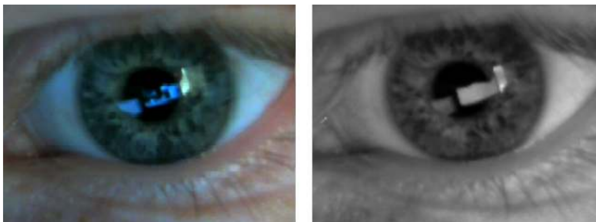
Obr. 14. a) vstupní barevný obraz b) obraz převedený na odstíny šedé
