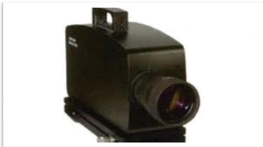
Obr. 6 – Druh laserového odposlechu
