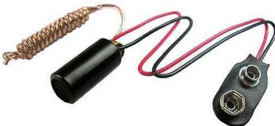
Obr. 4 – Odposlouchávací zařízení pro telefonní zařízení
