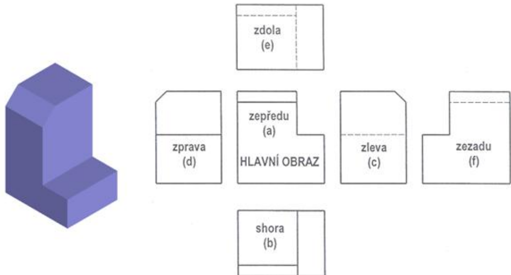
Obr. 19 Metoda promítání v 1. kvadrantu – rozložení obrazů. [6]
