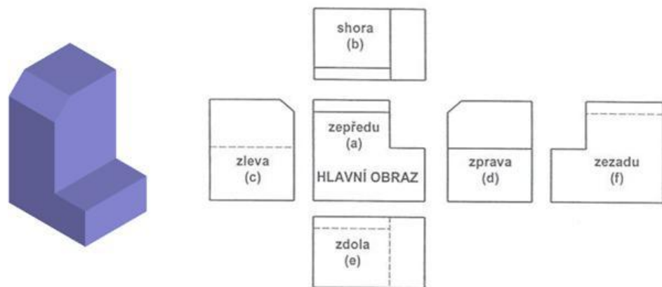
Obr. 23. Metoda promítání v 3. kvadrantu - rozložení obrazů. [6]
