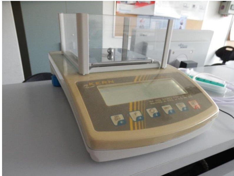
Obrázek 12 Referenční měření specifické hmotnosti: Vážení
