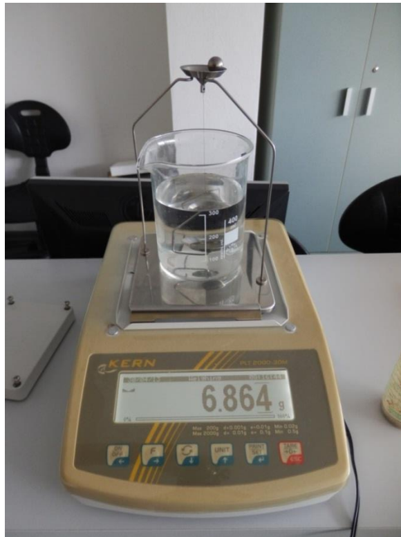
Obrázek 13 Referenční měření specifické hmotnosti: Vážení ve vzduchu
