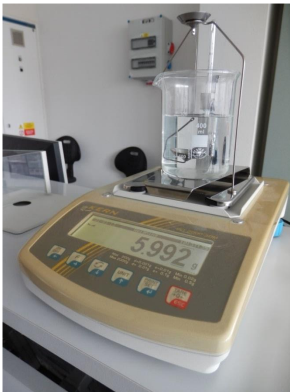
Obrázek 14 Referenční měření specifické hmotnosti: Vážení v kapalině
