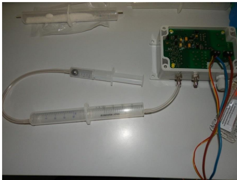
Obrázek 16 Referenční měření specifické hmotnosti: Měření objemu kuličky navrhouanou metodou
