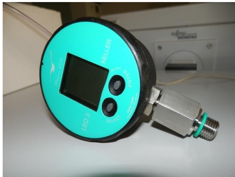
Obrázek 11 Digitální manometr KELLER LEO 3
