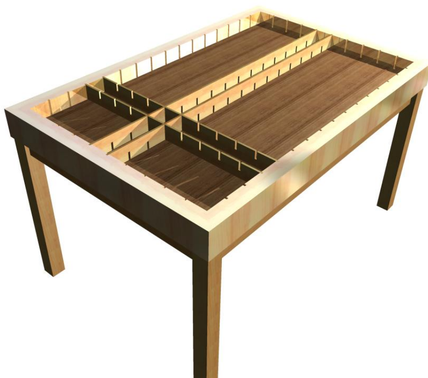
Obr. 17 Konstrukce stolu
