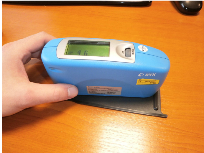
Obr. 33 – ukázka práce s přístrojem na měření lesku od firmy BYK
