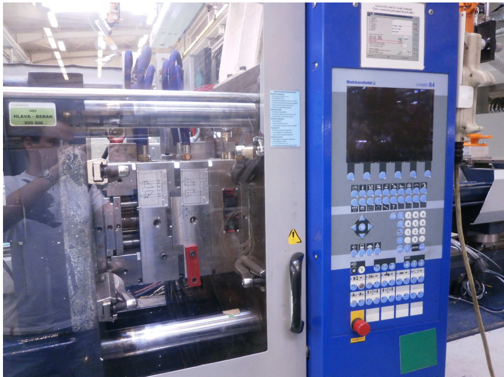
Obr. 35 – Vizualizace uchycení formy na stroji a ovládací jednotky.
