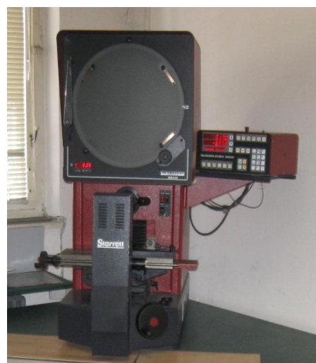
Obr. 17 Kontrolní měřicí přístroj IMPACT a Profil Projektor Starrett (vlastní zpracování)
