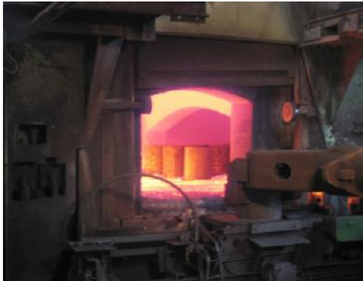
Obr. 19 vsádka polotovarů do pece
