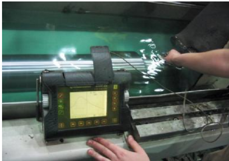
Obr. 61 Ultrazvukové imerzní zkoušení (ponorné ve vazebním prostředí)
