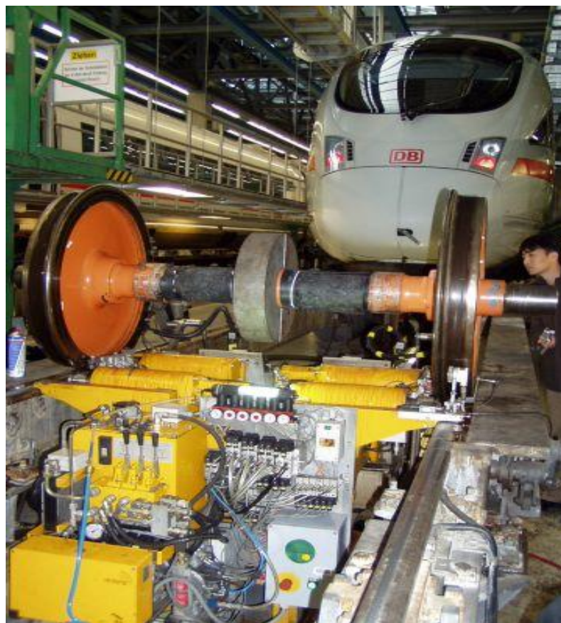
Obr. 62 Provozní zkoušení ultrazvukem
