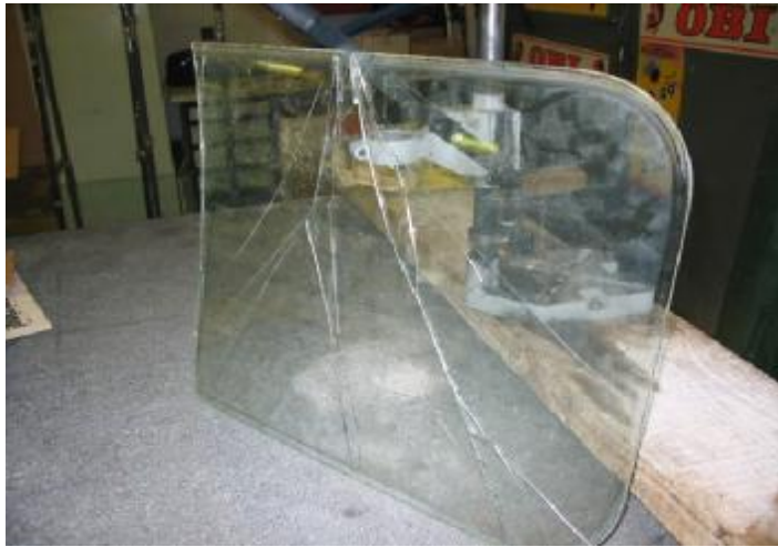
Obr. 32 Lepené sklo po deformaci
