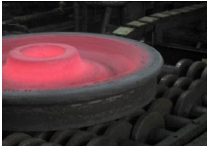
Obr. 23 kalení proudící vodou
