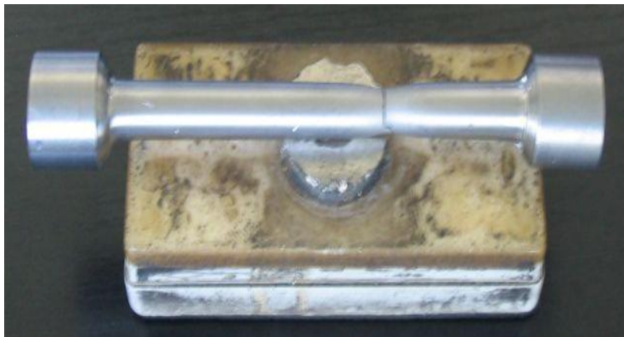
Obr. 6 Přetržená zkušební tyčinka
