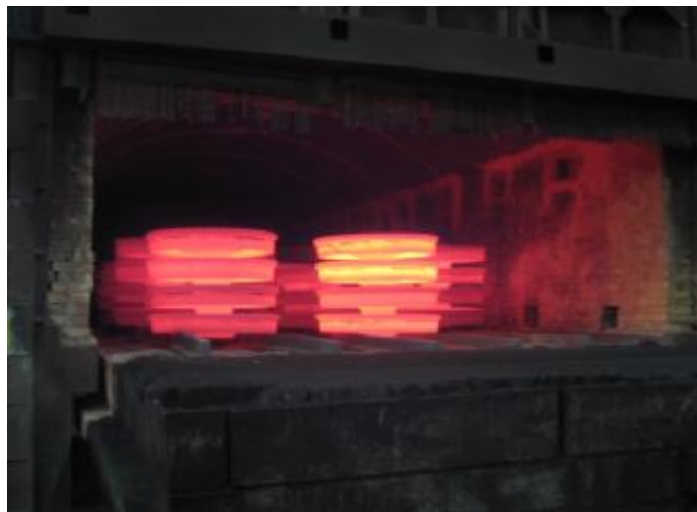
Obr. 22 Po tvářecím procesu ohřev na kalicí teplotu
