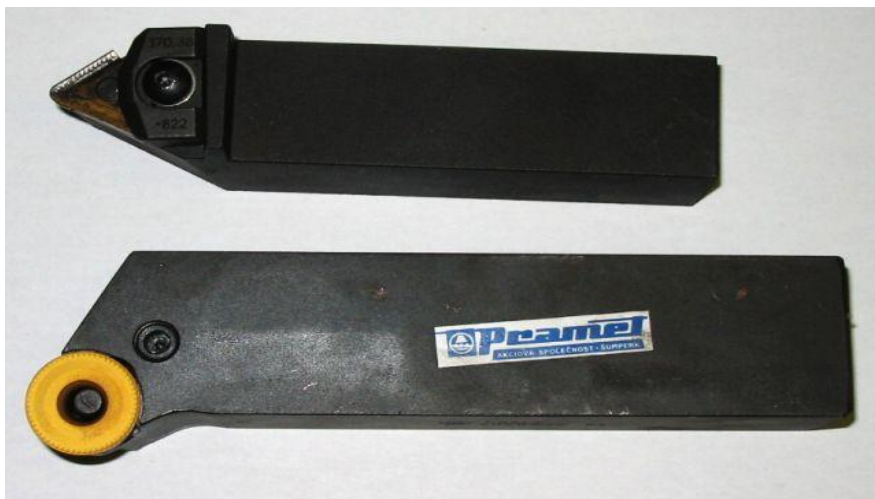
Obr. 36 Soustružnický nůž s obráběcí destičkou
