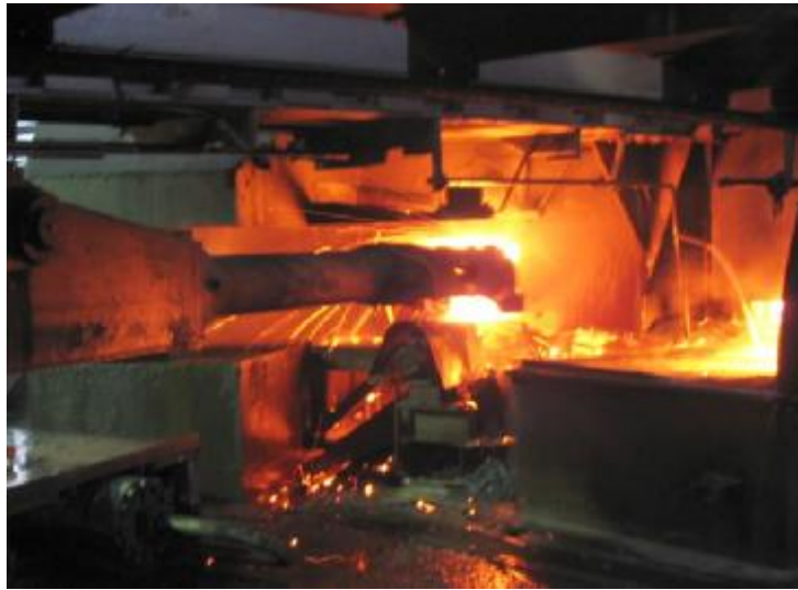
Obr. 21 Zbavení okují po vytažení z pece
