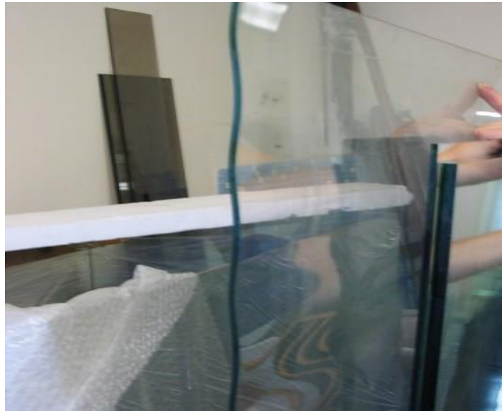
Obr. 30 Kalicí teplota byla překročena, dochází k deformaci kaleného skla
