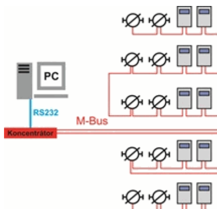
Obrázek 23 - Sběr dat na sběrnici M-Bus [20]
