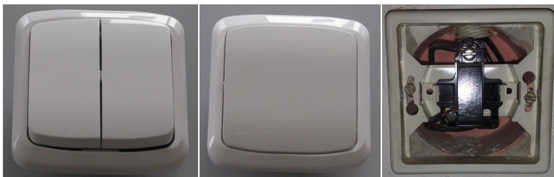
Obrázek 10 - Tlačítkové vypínače a vnitřní mechanismus
