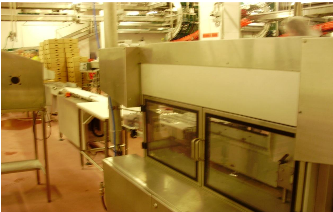
Obr. č. 6 Linka na balení masa do ochranné atmosféry (vlastní balící a plnicí hlava) 2
