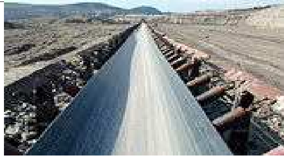
Obrázek č. 13. Technická tkanina na výrobu dopravníkových pásů [zdroj 21]
