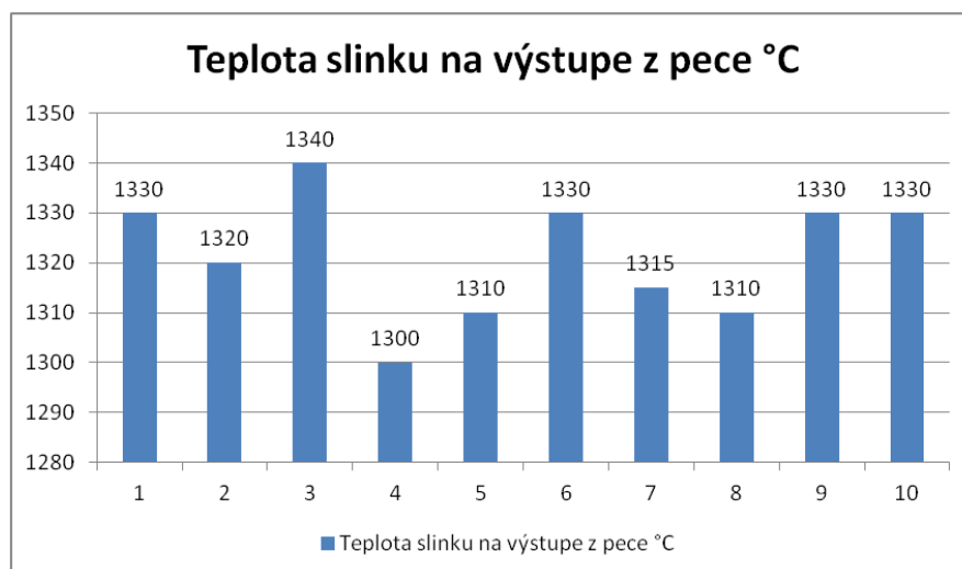
Obr. 45 Graf teploty slinku na výstupe z pece (Vlastné spracovanie)
