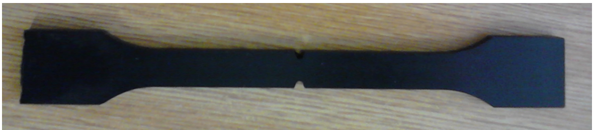
Obrázek 17 – Náčrt tělesa s vruby pro tahovou zkoušku
