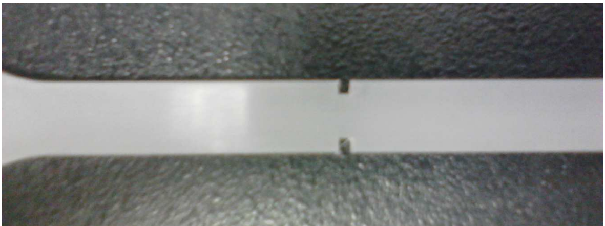
Obrázek 18 – fotografie tělesa s vruby pro tahovou zkoušku
