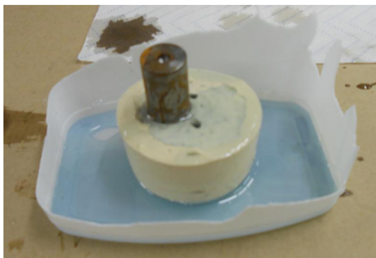
Obr. 23. Zatížená lukoprenová forma ozubeného kola po odlití epoxidové pryskyřice
