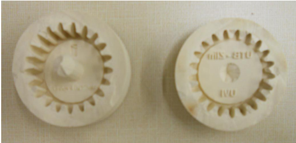
Obr. 18. Dvoudílná lukoprenová forma ozubeného kola
