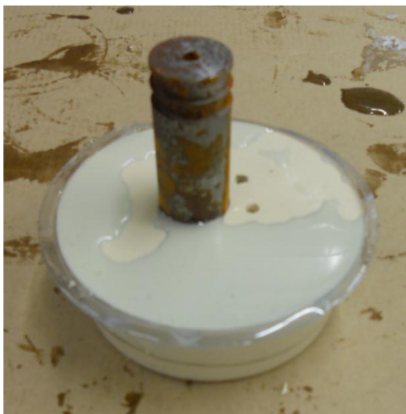
Obr. 22. Zatížená lukoprenová forma ozubeného kola po odlití epoxidové pryskyřice
