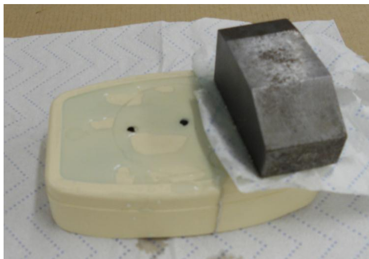
Obr. 21. Zatížená lukoprenová forma klíče s otvírákem po odlití epoxidové pryskyřice
