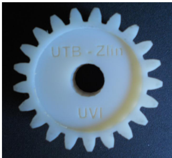
Obr. 16. Očištěný slévárenský model ozubeného kola
