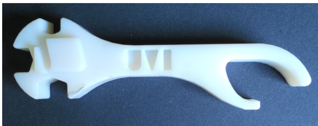
Obr. 17. Očištěný slévárenský model klíče s otvírákem
