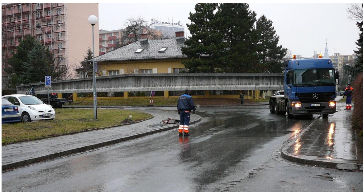
Obr. č. 9 Zvládnutí průjezdu křižovatky za pomoci druhého řidiče a řidiče doprovodného vozidla
