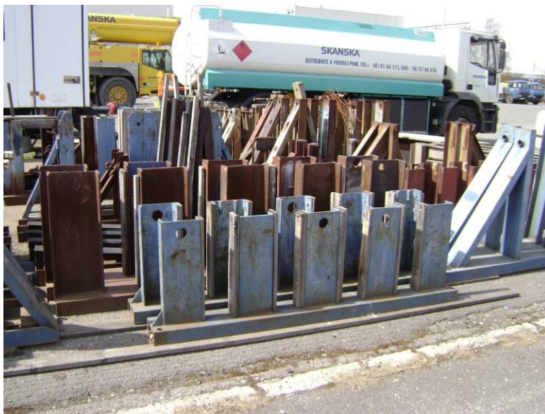
Obr. č. 7 Fixační prostředek pro vaznice tzv. hřeben
