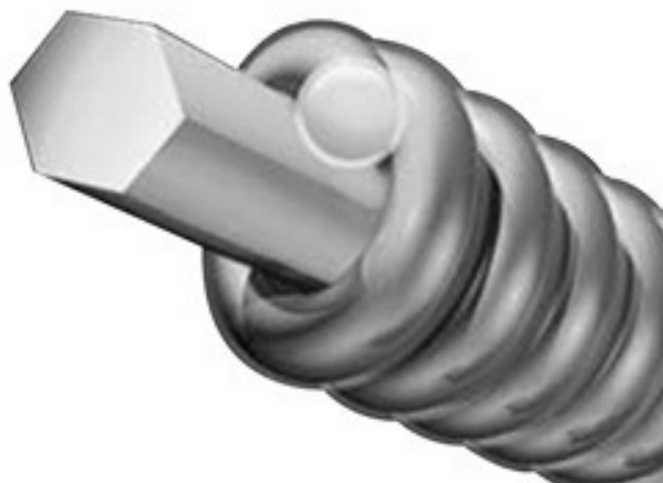
Obr. 4. Složení kytarové struny [1]
