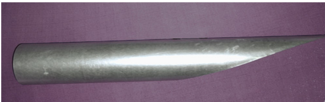
Obr. 51 Rúra na RONJU , plech 0,8mm
