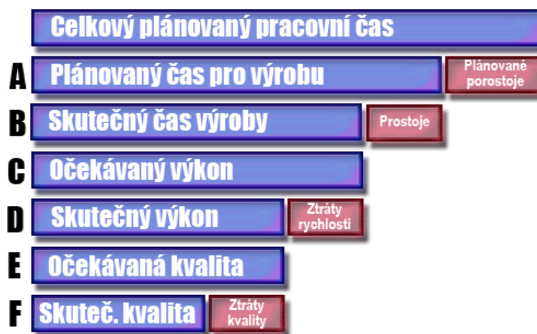
Obrázek 8 Parametry pro výpočet OEE (zdroj: Volko, © 2009)
