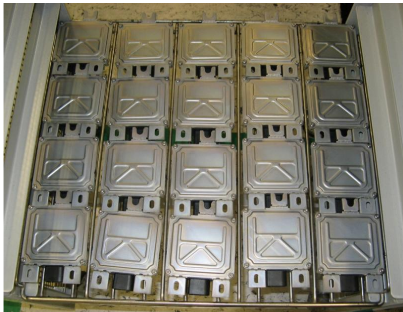
Obrázek 25 Současný způsob uložení výrobků B v roštu (zdroj: vlastní)
