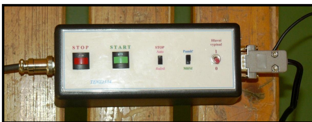
Obr. 22: Tenzometrické měřidlo s pamětí
