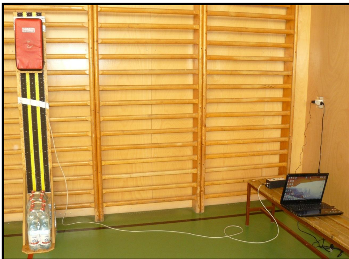
Obr. 21: Měřicí stanoviště dynamických vlastností úderu
