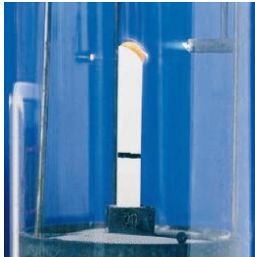
Obr. 10. Ukázka zkoušky metodou kyslíkového čísla „LOI“ [5].
