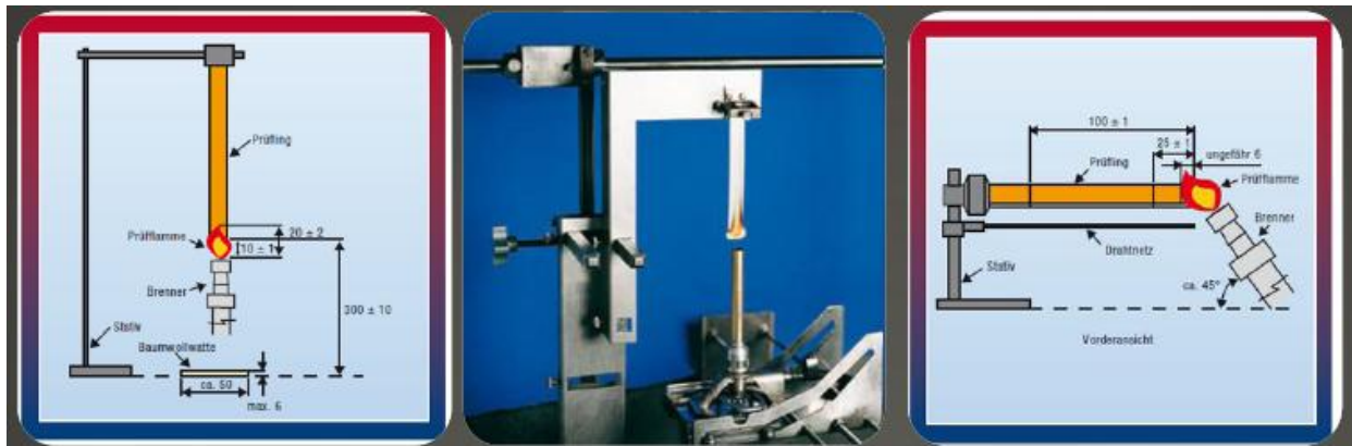
Obr. 11. Ukázka uspořádání testovací metody UL 94 [5].
