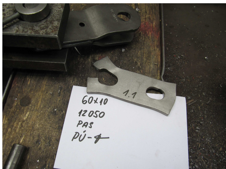
Obr. 33 - Zkušební těleso po zkoušce tahem
