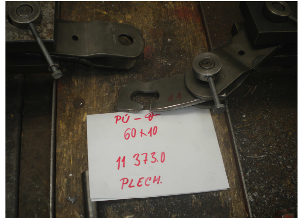
Obr. 26 - Zkušební těleso po zkoušce
