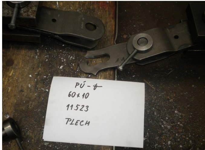
Obr. 37 - Zkušební těleso po zkoušce tahem -
