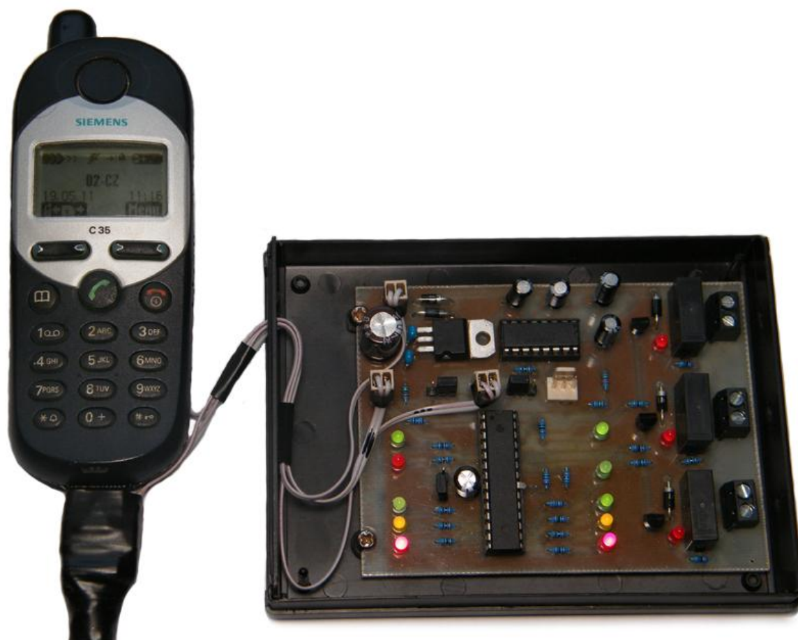
Obr. 24. Spínač připojený k mobilnímu telefonu Siemens C35i.
