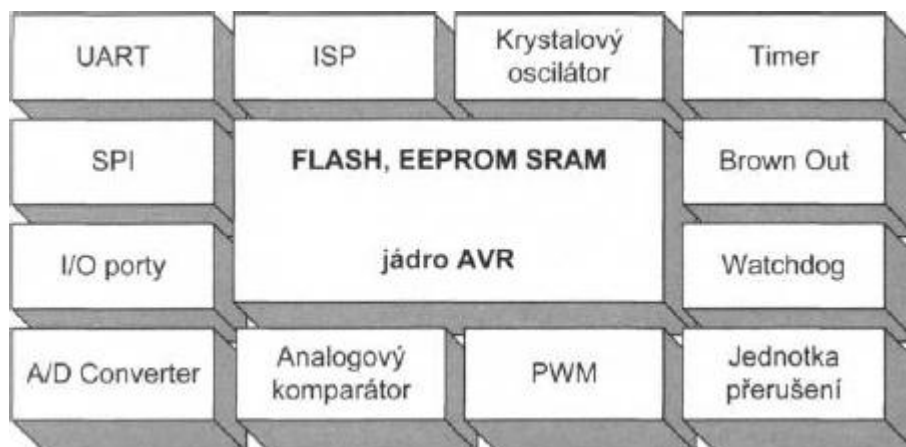
Obr. 5. Funkční bloky u jednotek MCU typu AVR.
