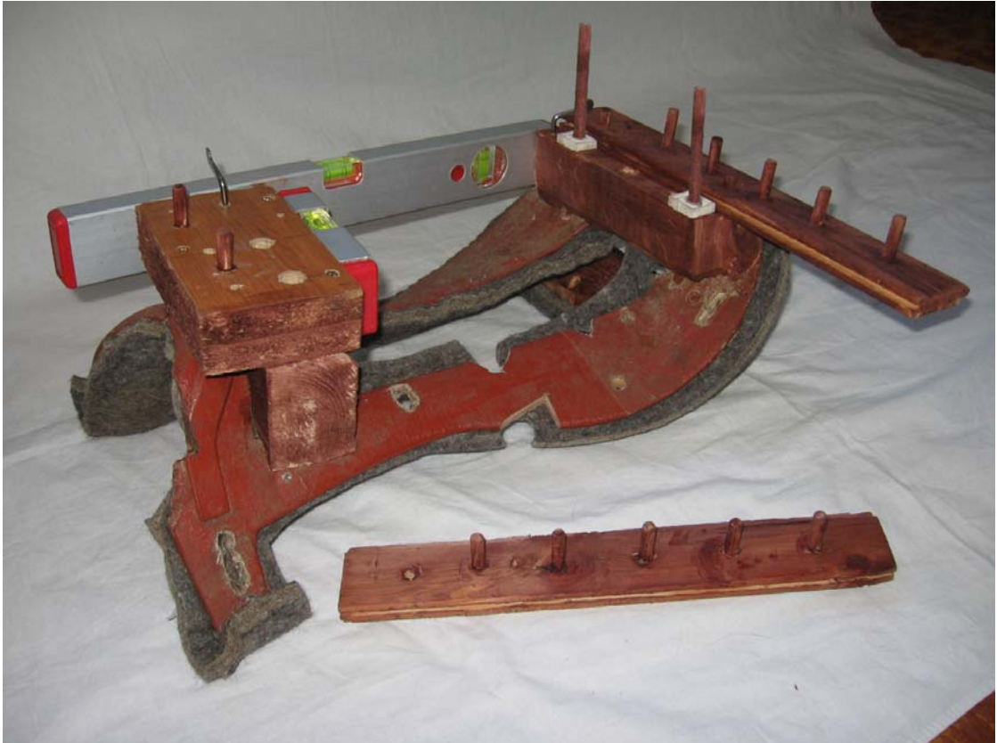
Obr. 29. Příčná lišta umístěná na konstrukci prototypu č. 2
