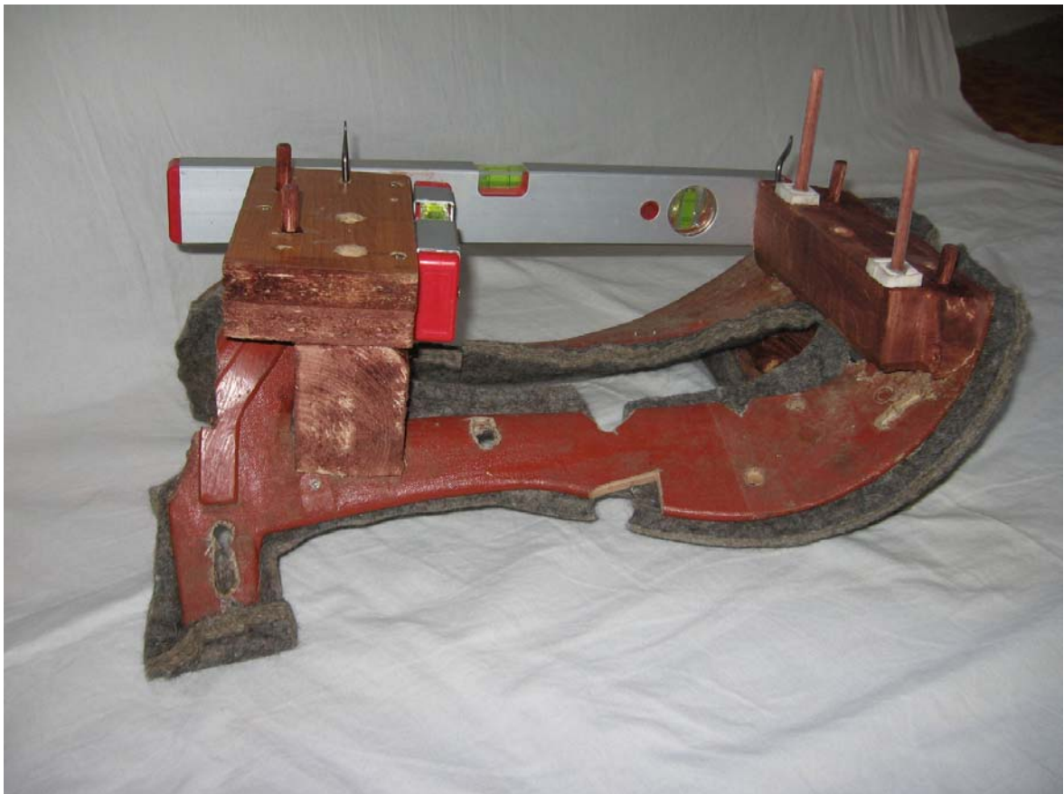
Obr. 28. Základ prototypu č. 2 postavený na sedlové kostře
