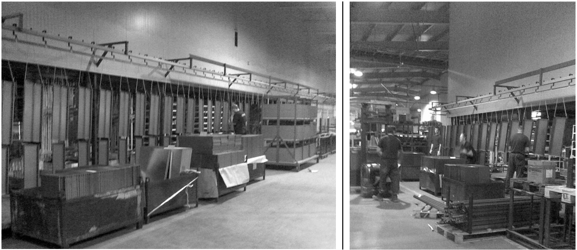
Obr. 34. Ukázka rozmístění přepravek dílů pro operaci navěšování [Vlastní zpracování]
