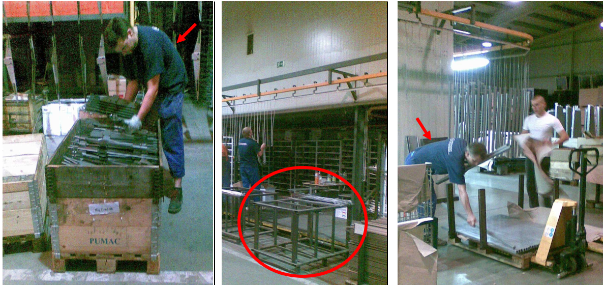
Obr. 37. Ukázka ergonomicky nevhodného umístění přepravek a vyvýšené konstrukce pro palety s materiálem pro lakování [Vlastní zpracování]
