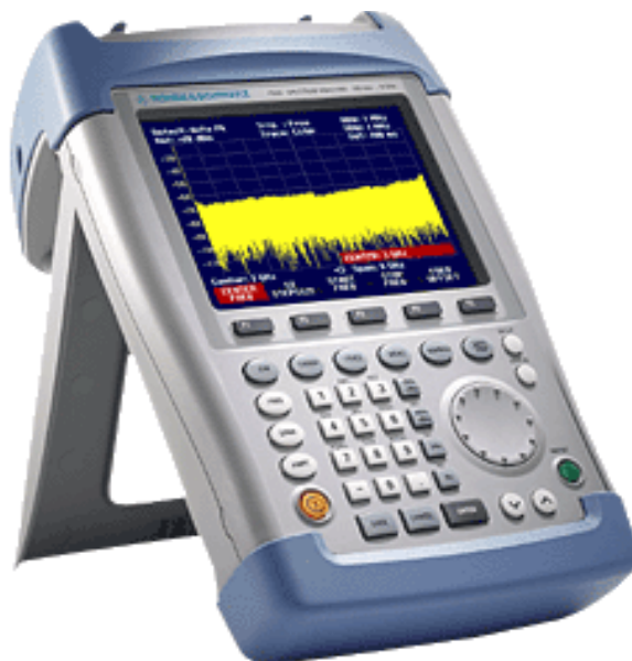
Obr. 46. Spektrální analyzátor R&S FSH3
