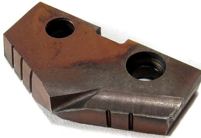
Obr. 25. Břítová destička kopinatého vrtáku
