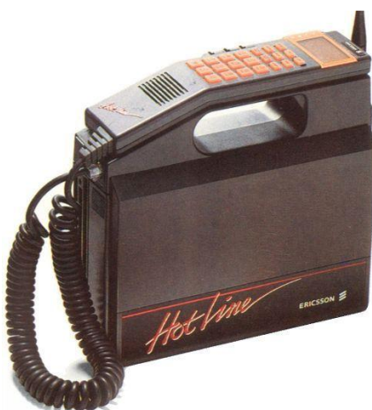
Obrázek 6.: Mobilní stanice užívané v AMPS [28]
