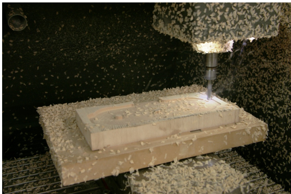
Obr. 46 Výroba rozvodného bloku z Necuronu 605
